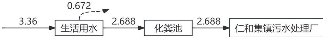
图 2-1 项目水平衡图 (t/a)
